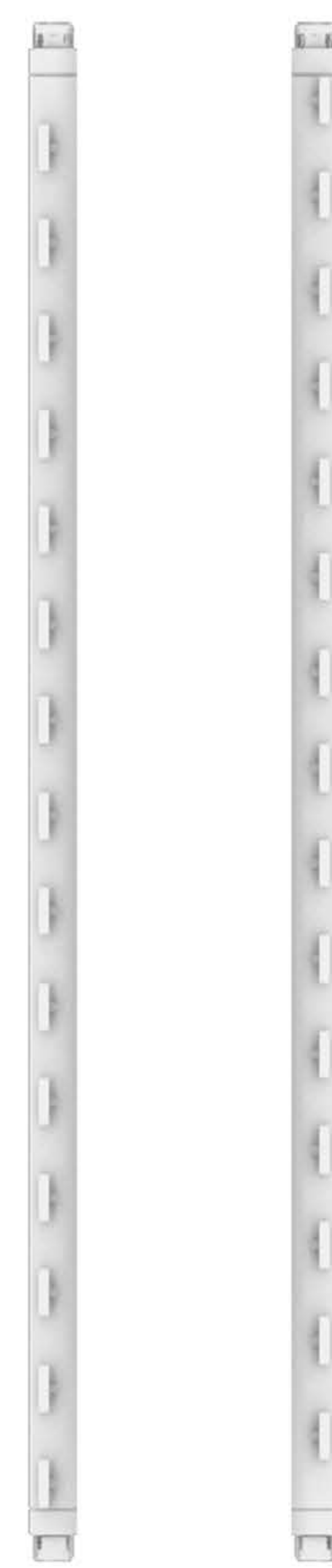
Μονάδα συστήματος σκίασης - θέση ανοιχτή
