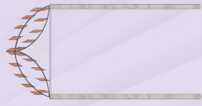
ΤΟΜΗ ΟΡΟΦΟΤ ΣΥΣΤΗΜΑ ΣΚΙΑΣΤΡΟΤ ΣΕ ΑΡΧΙΚΗ ΘΕΣΗ
