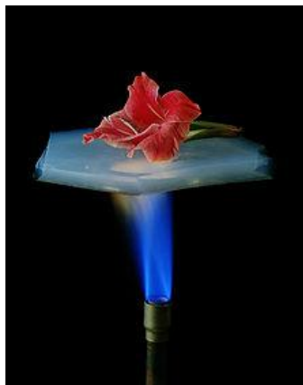
Εικόνα 71, Ένα λουλούδι πάνω σε ένα κομμάτι από aerogel το οποίο κρέμεται πάνω από ένα καυστήρα. Το λουλούδι είναι προστατευμένο από τη φλόγα. Πηγή :
