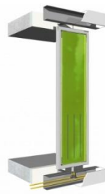
Εικόνες 80, Bioreactive Façade Πηγή:
