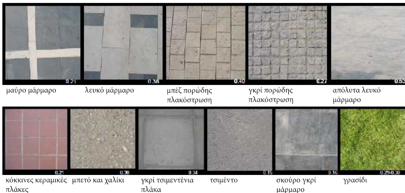
Σχήμα 90: Τα υλικά που μελετήθηκαν και οι συντελεστές ανακλαστικότητας τους.
