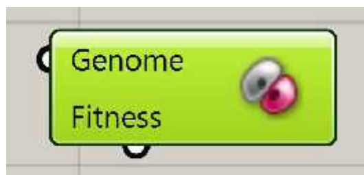
Σχήμα 124: Η εφαρμογή Galapagos. Αριστερά εισέρχονται οι παράμετροι και κάτω γίνεται η σύνδεση με την εκάστοτε συνθήκη.
