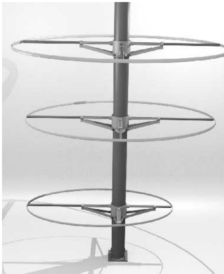
Σχήμα 119: Η τοποθέτηση των ελασμάτων και η οριστικοποίηση της μορφής των δαχτυλιδιών.
