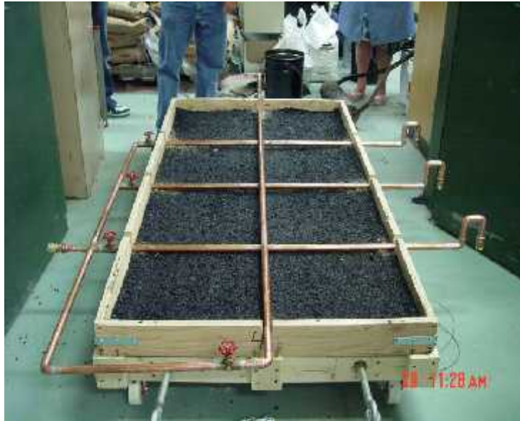
Σχήμα 98: Η πλάκα ασφάλτου και το δίκτυο σωληνώσεων πρίν την επικάλυψή του.
